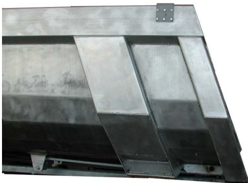
Particolare rinforzo posteriore
